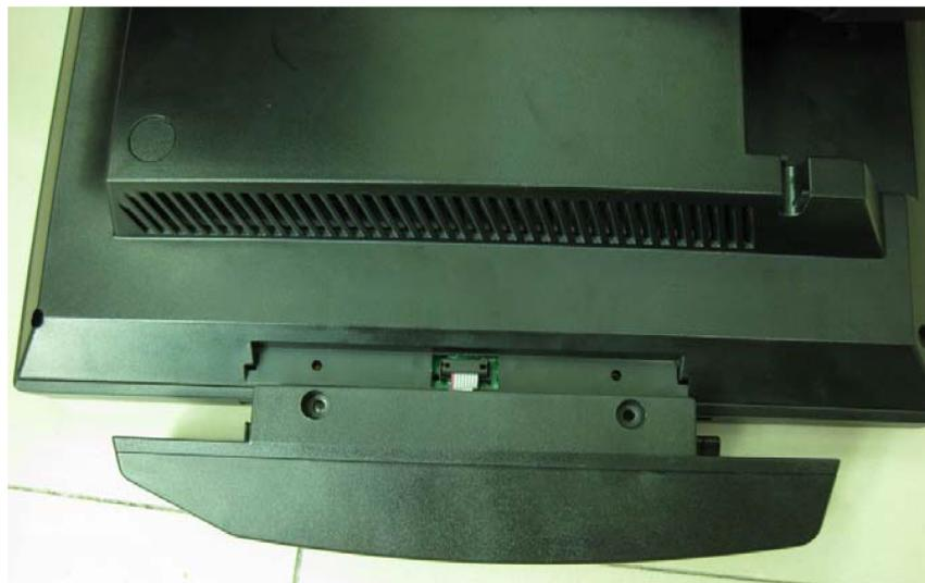
4) Atornille el módulo MSR a la cubierta posterior del panel
